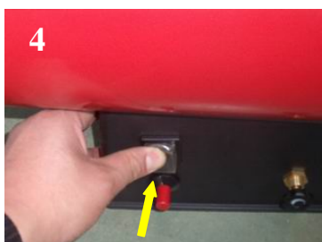
Aseta virtakytkin päälle asentoon "I"
