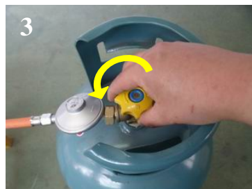
Avaa kaasupullon venttiili nuolen osoittamaan suuntaan
