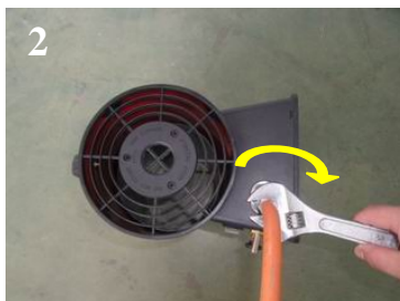
Kiristä liittimen mutteri nuolen osoittamaan suuntaan
